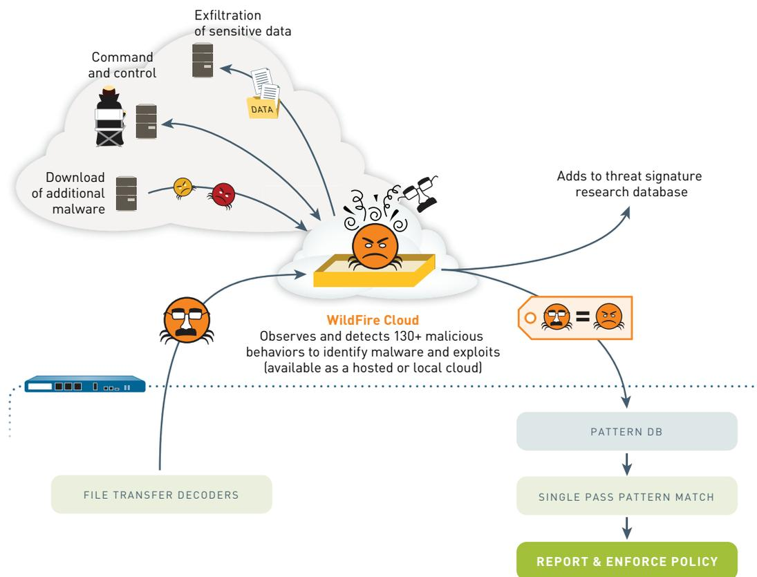
**Mode de fonctionnement de WildFire** : WildFire est l'association logique d'un pare-feu matériel nouvelle génération et d'une analyse des logiciels malveillants basée sur le cloud et évolutive.
